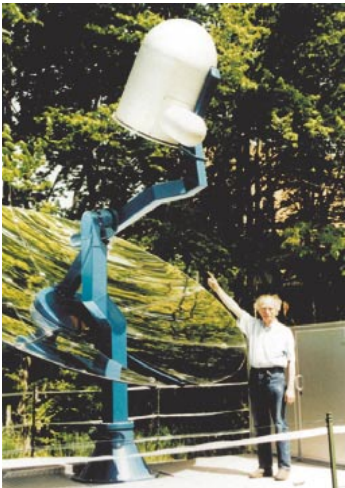
■ „Sonnenbefeuerter“ Stirlingmotor: Ein Vier-Meter-Hohlspiegel erzeugt 3000 °C im Brennpunkt. 80.000 Stunden soll der Stirlingmotor wartungsfrei arbeiten können.
